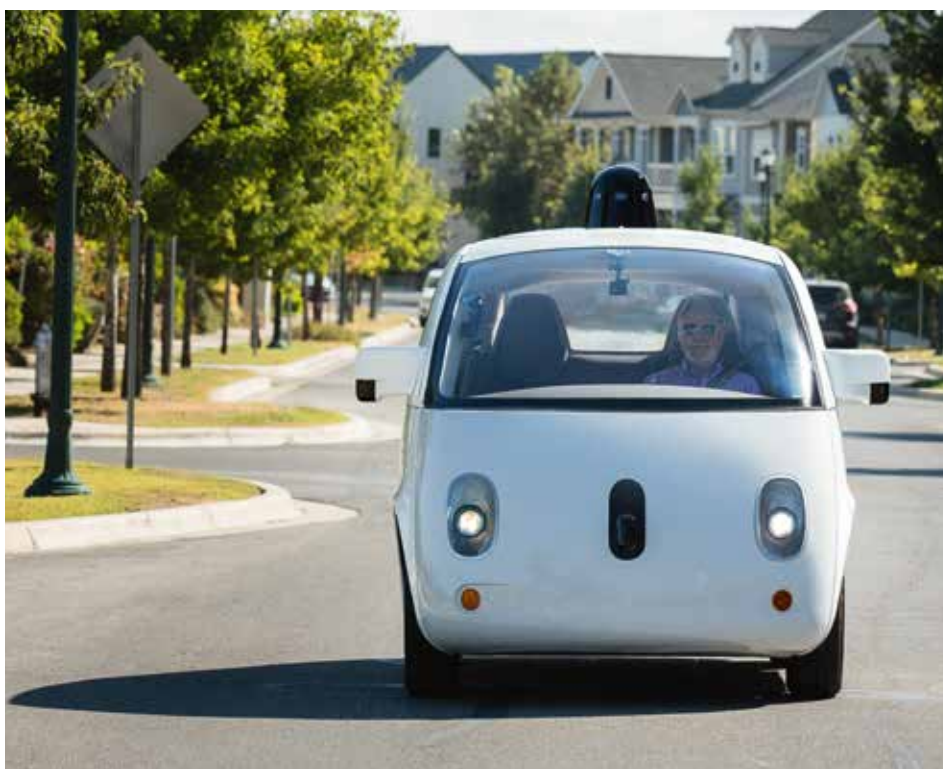
Firefly de la marque Waymo est un prototype fonctionnel de voiture autonome développé pour Google.
